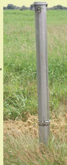
Préziomètre Outil de mesure du niveau de la nappe d'eau souterraine
