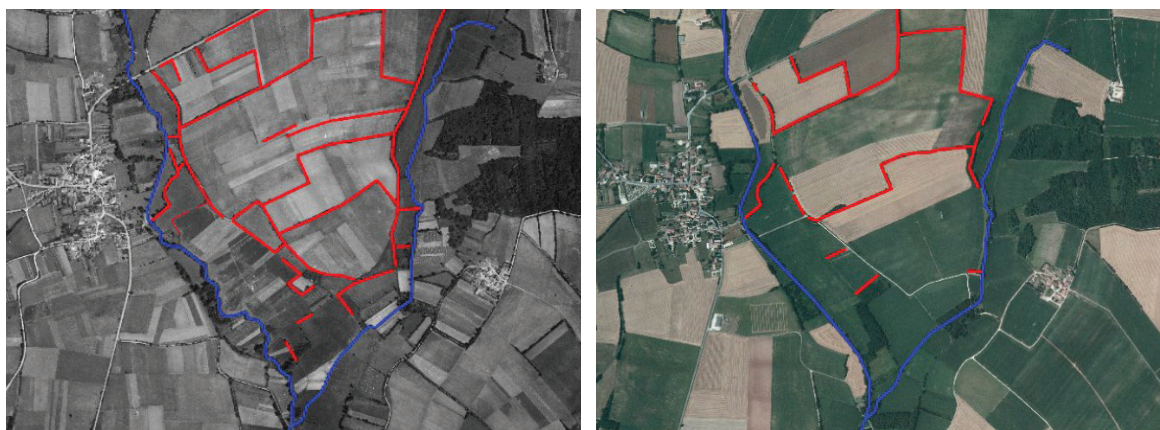
Figure 9 | Carte d'évolution du chevelu hydrographique (en bleu) entre 1950 et 2000 par rectification, recalibrage suite au remembrement. En rouge la régression associée du réseau de haies (sous-bassin de l'Aume-Couture) – © IGN
