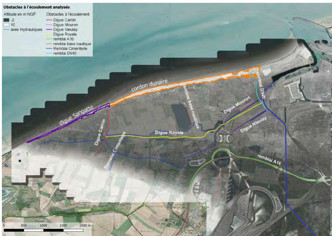
Figure 31 - Système de protection de Sangatte (source : Cerema)
