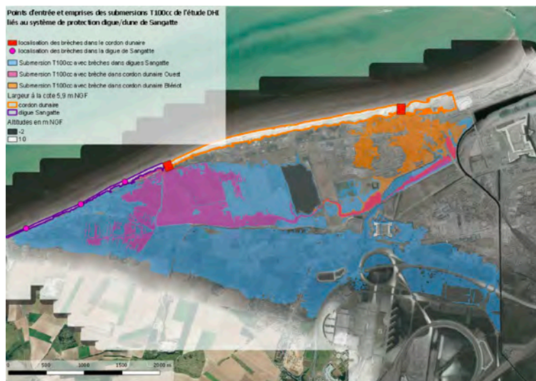
Figure 11 - Points d'entrée et emprises maximales des submersions simulées - d'après étude DHI sur le secteur Sangatte (source : Cerema)
