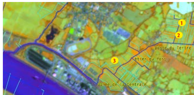
Le marais du Lot alimenté par l'étier du Port est contrôlé par la vanne de la centrale (sal. de 5,1 g/l), les mares 2 et 3 (sal. de 7,5 et 7,8 g/l) qui alimentent les rigoles, et le point de mesure de salinité 1 (7,7 g/l) sur une douve qui borde la prairie. Image en fausses couleurs : cours d'eau de la carte progressive de la préfecture du 44 en bleu, avec en cyan le réseau tertiaire.
