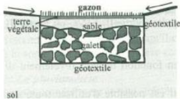
Figure 22 : Exemple de tranchée recouverte. Source : http://www.economie.grandlyon.com
