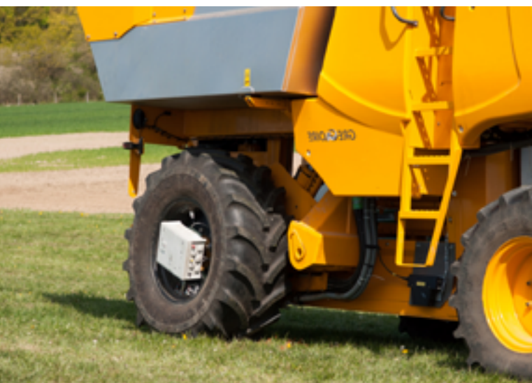
Prototype de pneu-capteur embarqué sur automoteur.
