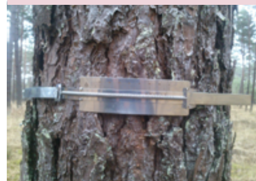
Dendromètre installé sur un pin sylvestre pour le suivi en direct de la croissance des arbres.
