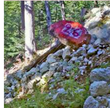
Expérimentation grandeur nature de lâcher de blocs en forêt sur le site de Vaujany (Isère).
