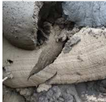
Boues chaulées issues d'un traitement classique (en haut) et du mélangeur Irstea (en bas).
