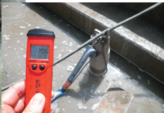
L'eau sur la paroi béton affichant pH 12.06 48 h après bétonnage.
