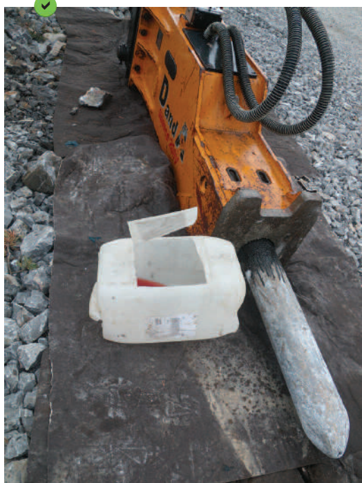
Équipement posé sur géotextile absorbant.
