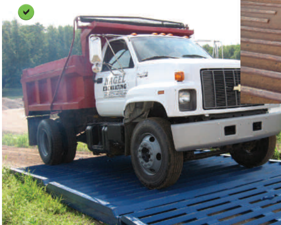
La longueur de la grille correspond à environ 10 fois le diamètre ou 3,5 fois la circonférence des roues. La forme ondulée écarte la gomme des pneus, ce qui fait tomber la boue et les cailloux incrustés.
