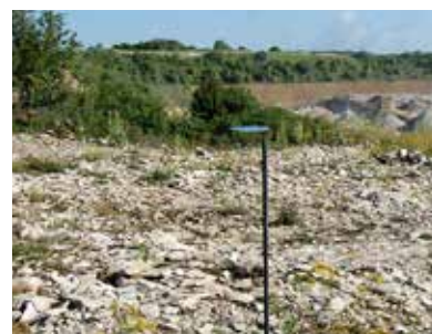
Plaquette de mesure de retombées de poussières
