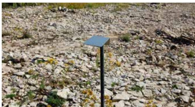
Plaque de mesure de retombées de poussières
