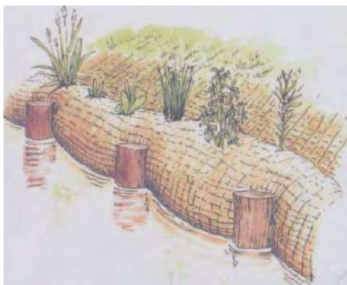
Figure 25 : Partie d'un des panneaux pédagogiques mis en place près du Seltzbach à Kutzenhausen pour montrer à quoi ressemblent les fascines d'hélophytes (LE BRETON, 2004).
